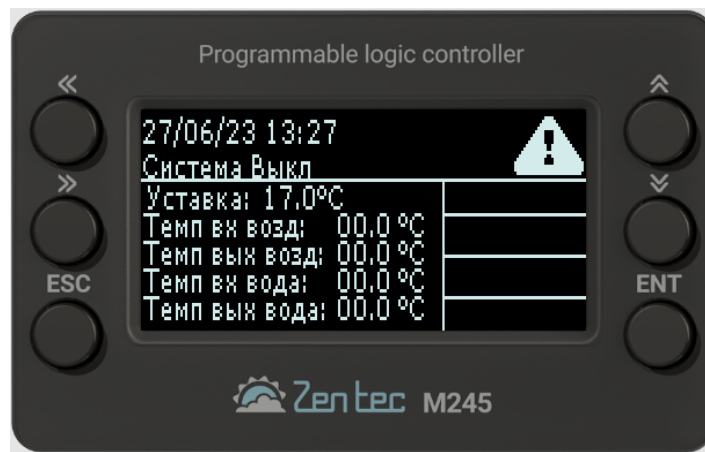
Рис. 2 Передняя панель контроллера Zentec M-245 (Водяной ПК)
